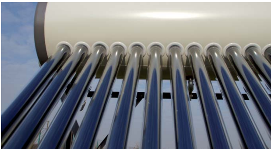
W kolektorach wodnych rury próżniowe są bezpośrednio zintegrowane z zasobnikiem ciepłej wody. Brak wymiennika eliminuje straty ciepła
