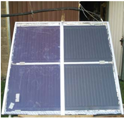
Rys. 2. Kolektor wykonany domowym sposobem – grzejniki stalowe zamontowane w ramie okiennej (źródło: elektroda. pl)
